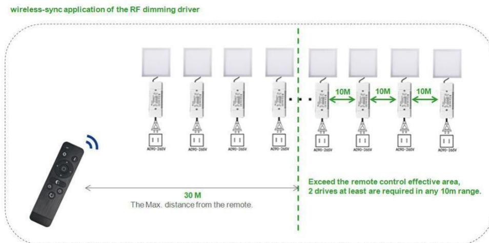
El rango de detección del sistema **2.4G Smart** no se limita con el radio de detección del mando de distancia. En espacios grandes los drivers amplifican la señal entre ellos con 10m
